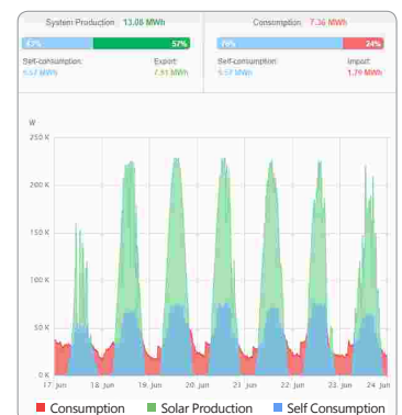
Voorbeeld uit het SolarEdge monitoring platform dashboard van één week PV-energieproductie en -verbruik
